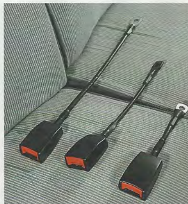
Entsprechend der Einbauposition muss die passende Gurtpeitsche ausgewählt werden. Es gibt unterschiedliche Längen
