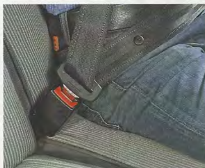
Richtig: Im Optimalfall kommt das Schloss mit dem Körper nicht in Kontakt. So sitzt der angelegte Gurt auch bequemer
