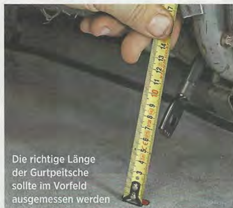
Entsprechend der Einbauposition muss die passende Gurtpeitsche ausgewählt werden. Es gibt unterschiedliche Längen
