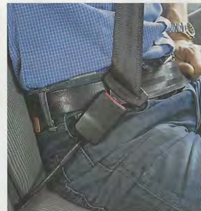
Falsch: Das Schloss darf nicht auf dem Beckenknochen aufliegen. Dies birgt Verletzungsgefahren bei einem Unfall
