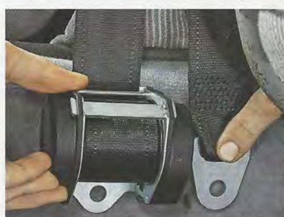
Die Position der Gurtrolle ergibt sich, denn sie sitzt möglichst senkrecht unterhalb der Umlenkung. Der vierte Aufnahmepunkt ist direkt davor
