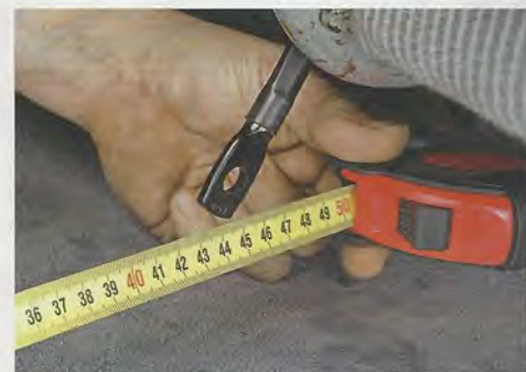
Die Peitsche darf nicht senkrecht nach oben ragen, sondern muss leicht nach vorne geneigt sein, damit der Gurt bei einem Unfall schneller blockiert
